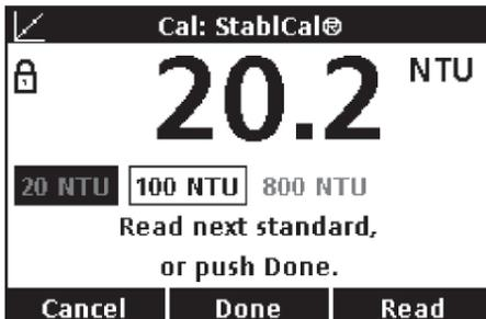
Lorsque vous utilisez le mode étalonnage complet (0 à 1 000 NTU), la fonction d'étalonnage assisté vous guide pas à pas grâce aux instructions qui s'affichent à l'écran et vérifie automatiquement la précision de l'opération. Avec cette fonction d'assistance, vous n'avez plus besoin de vous référer à un quelconque manuel et vous êtes sûr que votre étalonnage est complet et valide.
