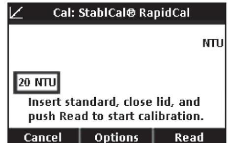
Etalonnage à un seul étalon RapidCal. Dans la plage allant jusqu'à 40 NTU, le mode d'étalonnage à un seul étalon RapidCal permet de réduire la complexité du processus en supprimant l'étalonnage complet avec plusieurs étalons. Vous gagnez ainsi du temps et remplissez les exigences de consignation des données.
